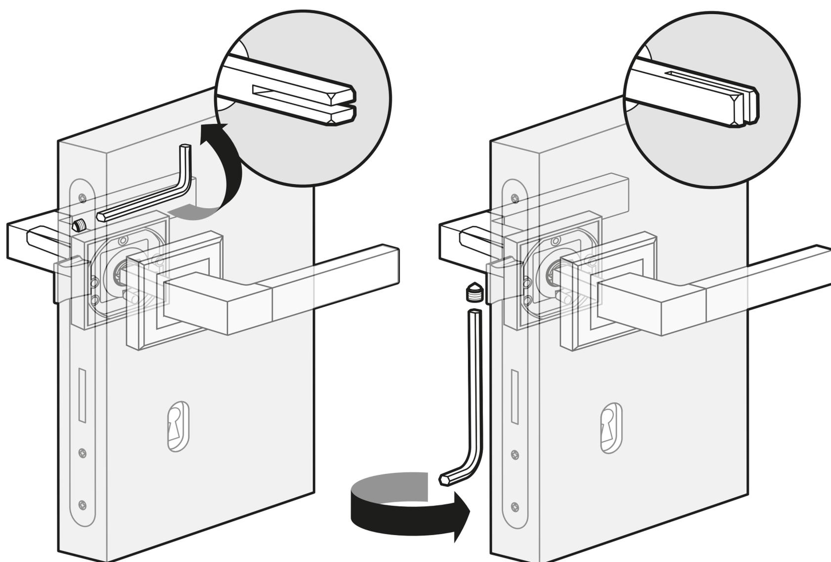
**PL:** W zależności od konstrukcji klamki i kierunku nacięcia w trzpieniu zamontowanym uprzednio w zamku należy mocno dokręcić śrubę imbusową od dołu lub boku klamki.
